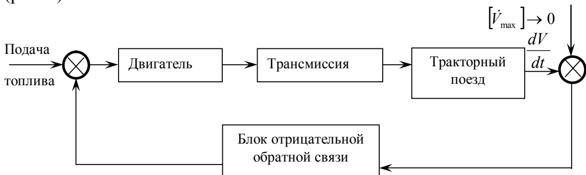
Рис. 2. Блок-схема системы автоматического регулирования синхронного движения комбайна и тракторного поезда.
