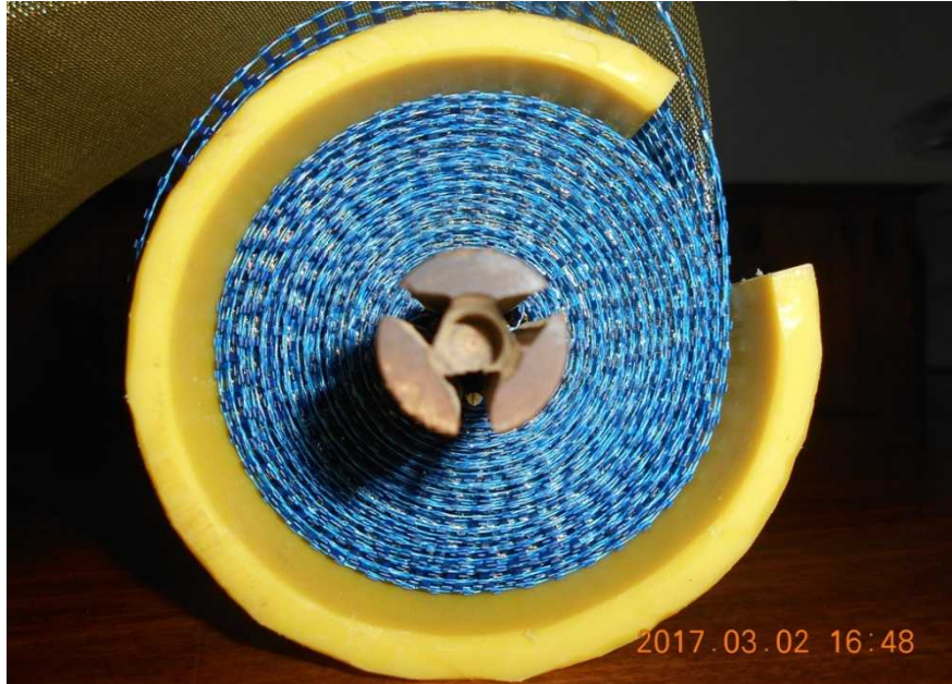
Рис. 1. Укладка сіток на стрижні
