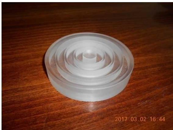
Рис. 4. Дно фільтру з профрезерованими канавками
