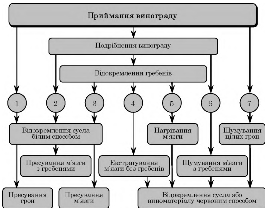
Рис. 1.90. Технологічні схеми переробки винограду білим (1, 2, 3) і червоним (4, 5, 6 і 7) способами
