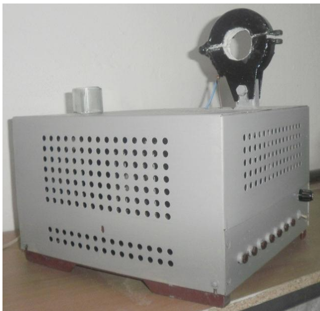
Рисунок 11.1 - Установка для електричного різання скляних труб
