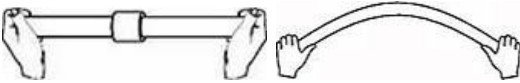
Рисунок 12.3 – Зварена муфтою деталь і згин труби
