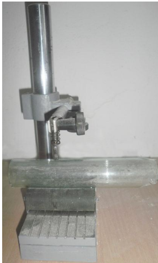
Рисунок 11.3 - Установка для різання скляних труб
