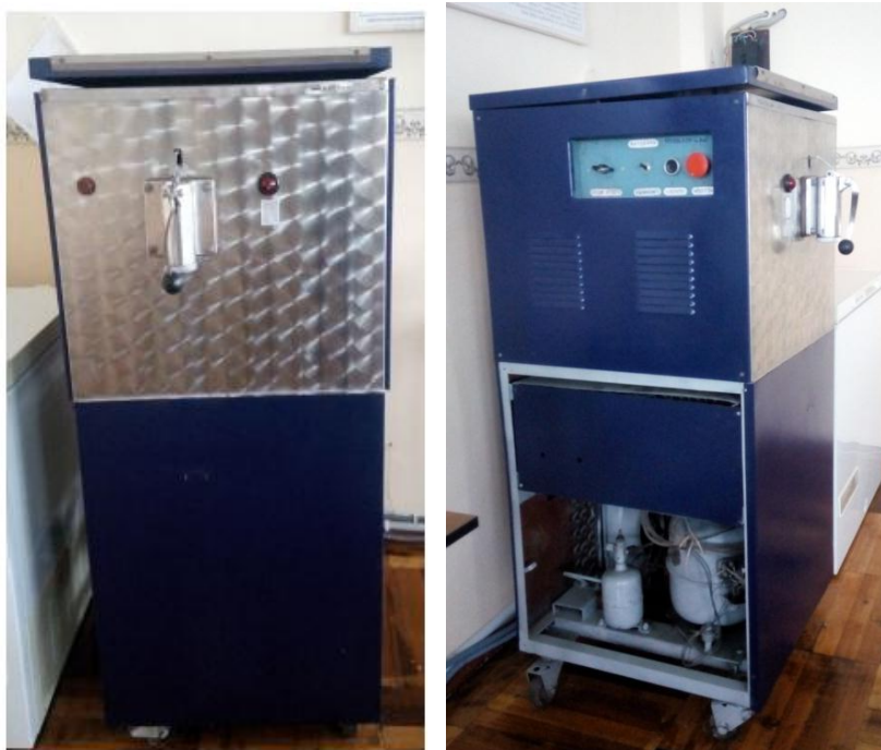
Рис. 7. Фотографія загального вигляду фризера для виробництва морозива
