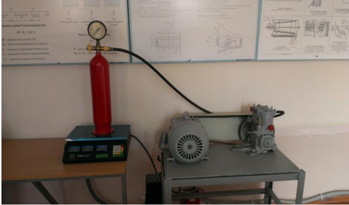
Рис. 2. Фотографія загального вигляду лабораторної установ- ки для експериментальної оцінки параметрів компресора об'ємної дії
