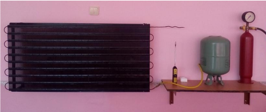
Рис. 3. Фотографія загального вигляду лабораторної установки для перевірки холодильного контура холодильної машини на відсутність витікання холодоагента за допомогою електронного галогенового течешукача WJL 6000.
