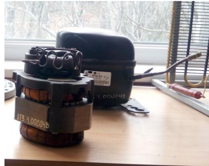
Рис. 12. Схема і фотографія герметичного компресора ФГ–0,1
