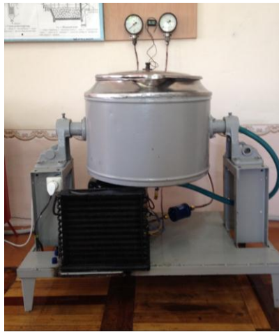
Рис. 2. Фотографія загального вигляду лабораторної установки для експериментальної оцінки параметрів парової компресійної холодильної установки
