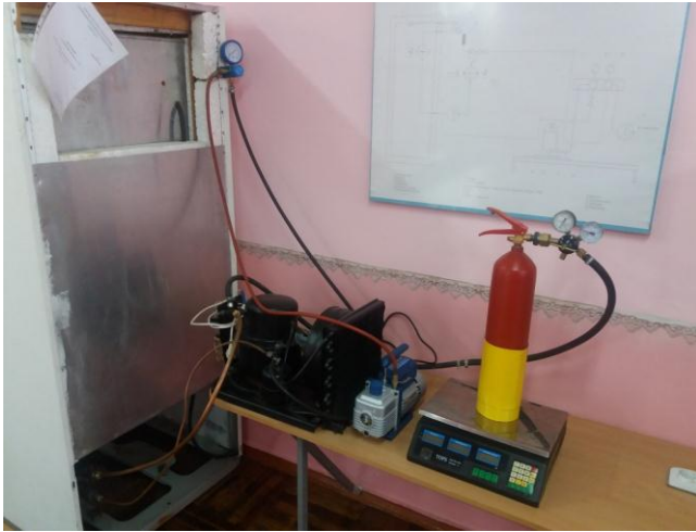
Рис. 4. Фотографія загального вигляду лабораторної установки для експериментальної оцінки параметрів парової компресійної холодильної машини.
