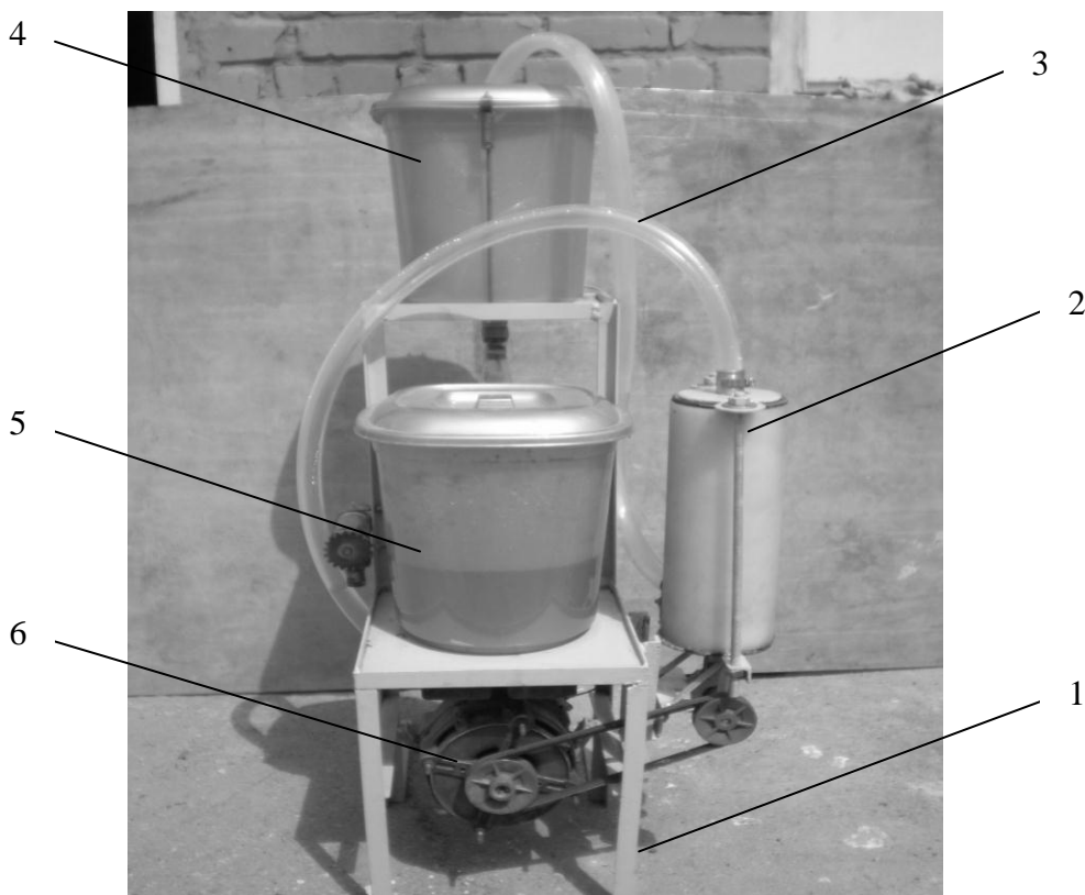
Рис. 1 Експериментальна лабораторна установка для гомогенізації рідких продуктів (позначення у тексті).
