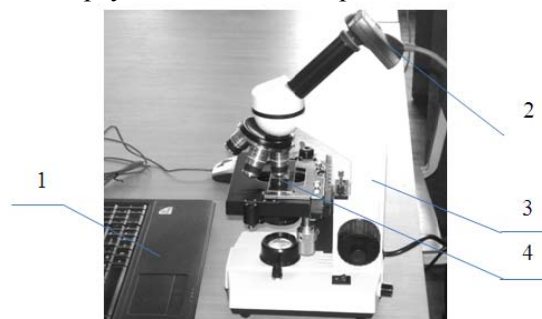
Рис. 4. Загальний вид мікроскопа з під'єднаною до комп'ютера веб-камерою: 1 – комп'ютер, 2 – цифрова камера, 3 – оптичний мікроскоп, 4 – дослідний зразок емульсії
