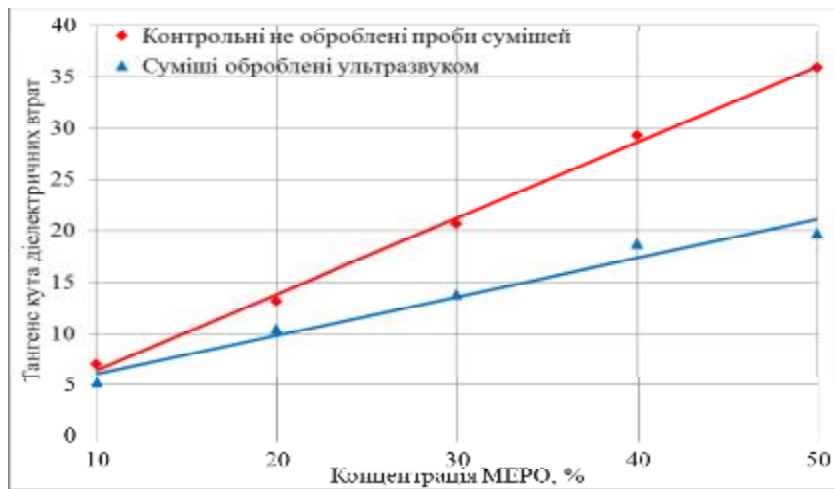
Рисунок 5 – Залежність тангенса кута діелектричних втрат від концентрації МЕРО в дизельному паливі до обробки і після обробки ультразвуковими хвилями
