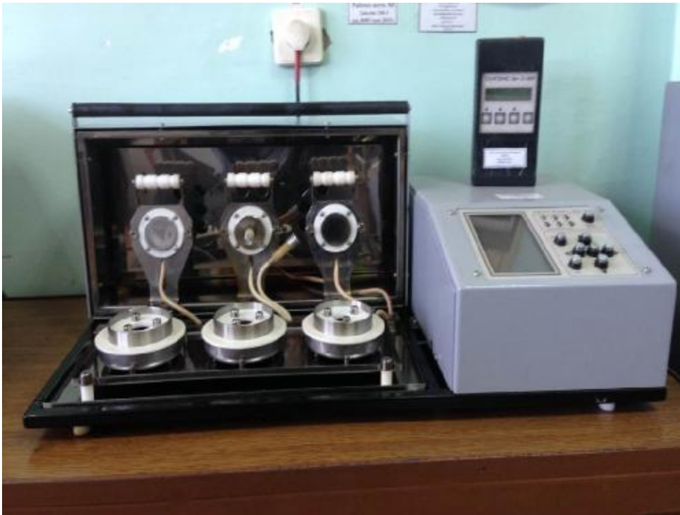
Рисунок 4 - Загальний вигляд установки для вимірювання діелектричних втрат рідких діелектриків «Тангенс – 3М-3»
