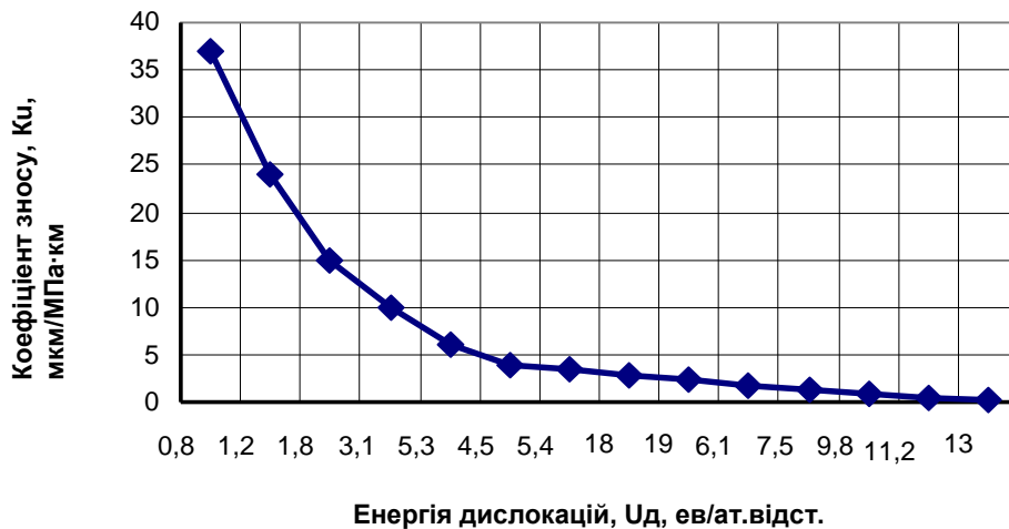
Рис.2. Залежність коефіцієнта зносу K_U від енергії дислокацій U_d .
