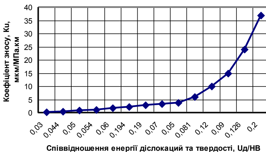
Рис.3. Залежність коефіцієнта зносу K_U від співвідношення енергії дислокацій U_d до твердості складових металів HB .
