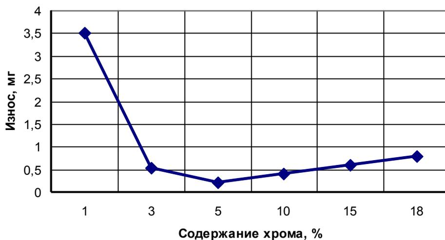
Рисунок 4- Зависимость износа сталей при трении в среде метанолов от содержания хрома
