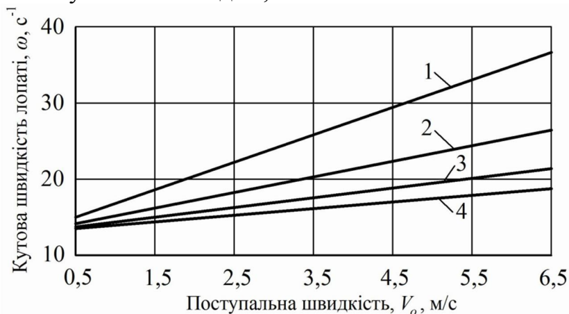
Рис. 6. Залежність кутової швидкості \omega від швидкості V_o поступального руху при різних значеннях довжини лопаті 2l : 1 – 2l = 0,1 м; 2 – 2l = 0,2 м; 3 – 2l = 0,3 м; 4 – 2l = 0,4 м.
