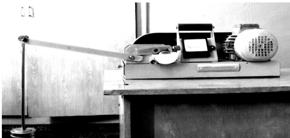
Рисунок 4 - Загальний вигляд машини тертя «Тімкена».
