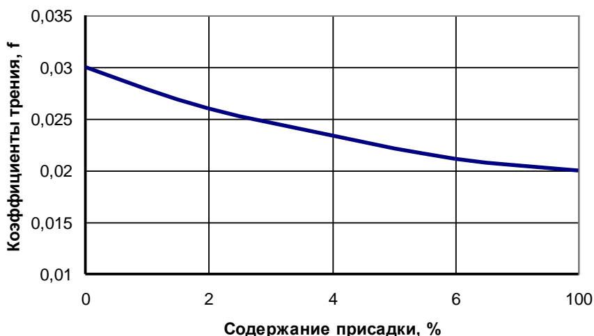
Рисунок 5 – Вплив кількості присадки на коефіцієнт тертя для мінеральних олій М8В
