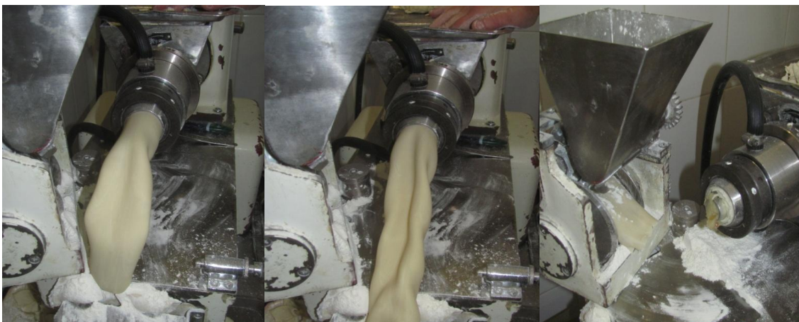
Рис.5. Принцип роботи пельменного комбайна.
