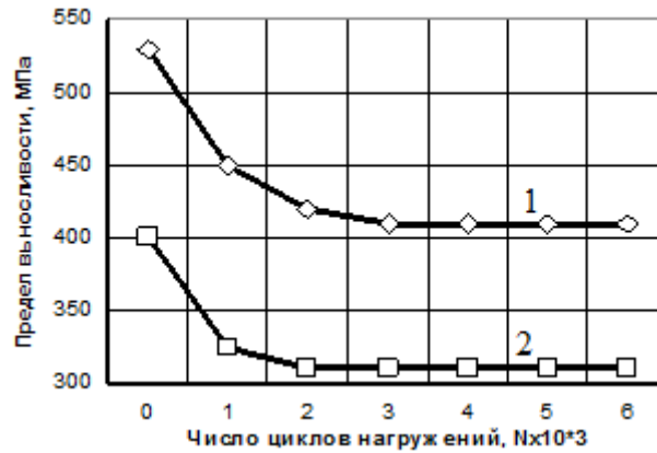
Рис. 3. Вплив шліфувального прижогу на межу витривалості сталі 40Х: 1 – без прижога; 2 – з прижогом
