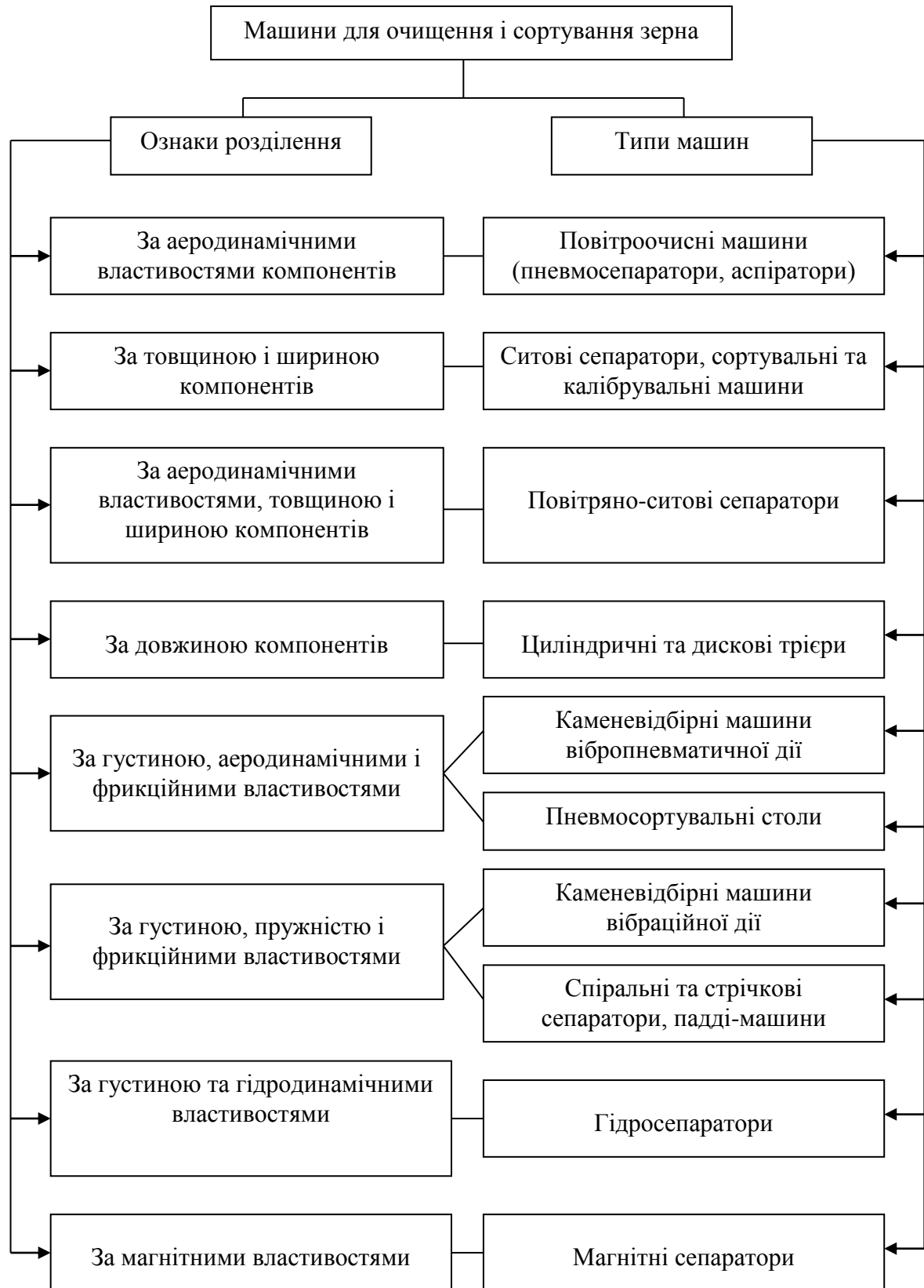
Рис. 1. Класифікація машин для очищення і сортування зерна.
