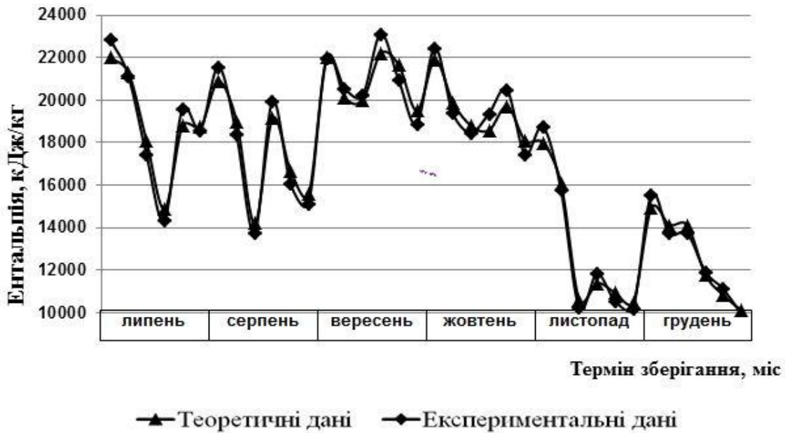
Рис. 2. Розподіл теоретичного та експериментального значення ентальпії у першому зерноховищі.
