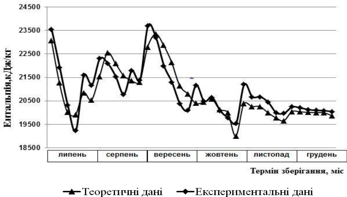
Рис. 2. Розподіл теоретичного та експериментального значення ентальпії у першому зерноховищі.
