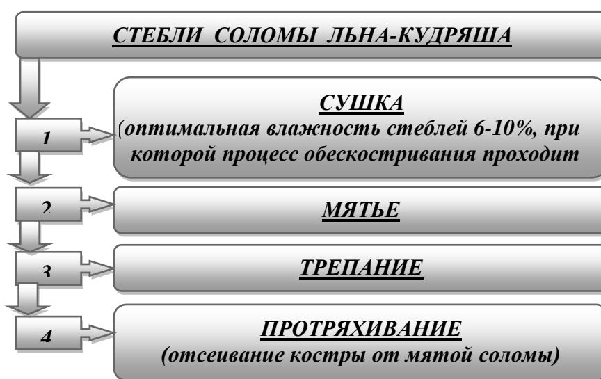
Рис. 1. Процесс выделения луба из соломы льна
