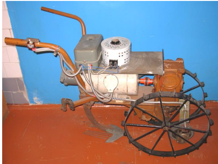
Рисунок 1 – Загальний вигляд дослідного зразка мотоблока МБ-КЭП Технічна характеристика мотоблока приведена в таблиці 1.
