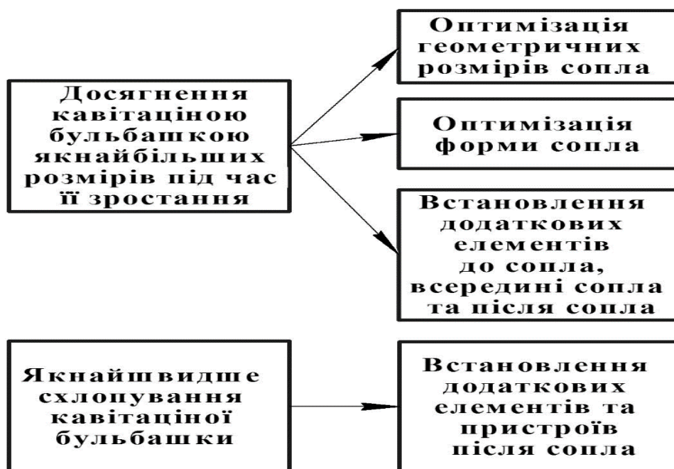
Рис. 2. Основні шляхи збільшення інтенсивності кавітації в соплі
