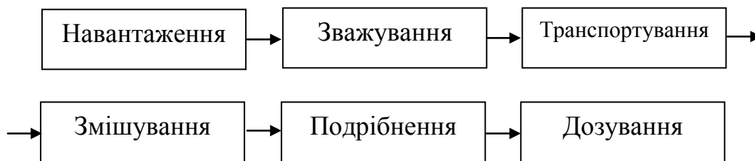
Рис. 3. Механічні процеси при прискореному компостуванні органічних відходів
