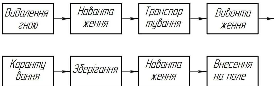
Рис. 1. Технологічний цикл виробництва органічних добрив на майданчиках тимчасового зберігання
