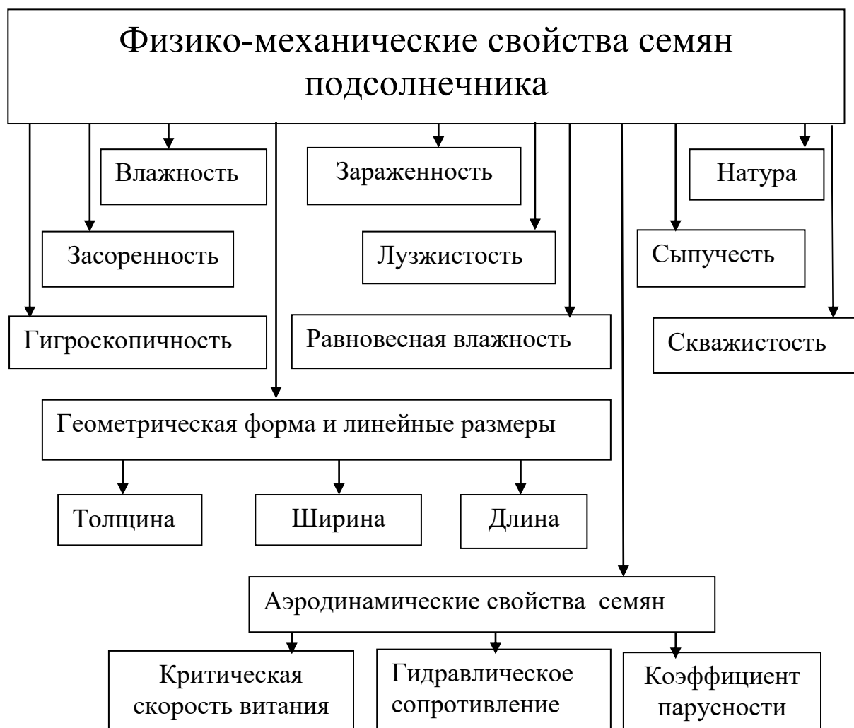
Рис. 1. Физико-механические свойства семян подсолнечника.
