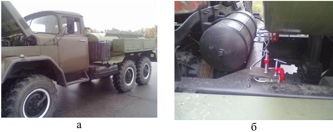
Рис. 1. Автоцистерна АРС-14 на базі автомобіля ЗІЛ-131 в ході проведення експериментальних досліджень: а – загальний вигляд автомобіля; б – кріплення на рамі трикоординатних датчиків прискорення.
