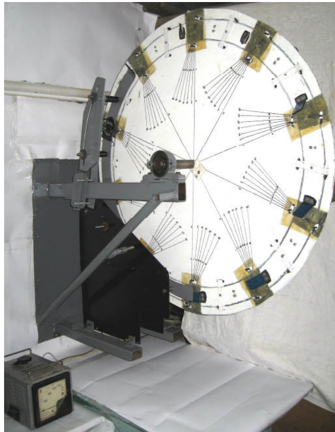
Рис.3. Схема (а) та загальний вигляд (б) стану для проведення лабораторних досліджень процесу роботи садильного апарата: 1 –сошник; 2 – диск; 3 – плунжерні фіксатори; 4 – орієнтуючий пристрій; 5 – копір; 6 – обмежувач вклядання підщеп у захвати; 7 – захват; 8 – упори; 9 – редуктор; 10 – електродвигун постійного струму; 11 – діодний міст; 12 – автотрансформатор (ЛАТР); 13 – пружини.
