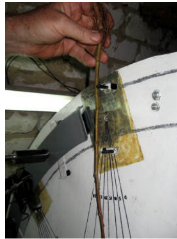
Рис.5. Процес вкладання підщеп у захвати садильного апарата.
