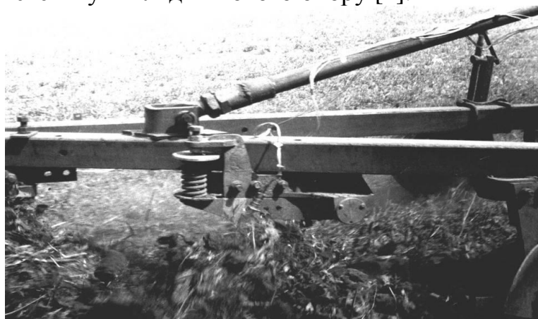
Рис. 1. Коливальна система корпус плуга на пружній підвісці.
