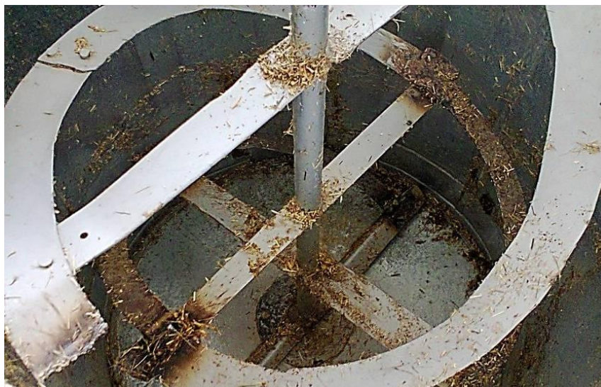
Рис. 2. Робоча камера лабораторного змішувача кормів.
