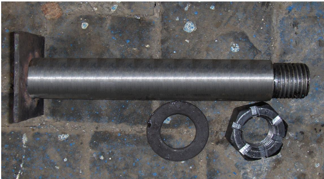
Рис. 8. Відновлений палець із конструктивними змінами.
