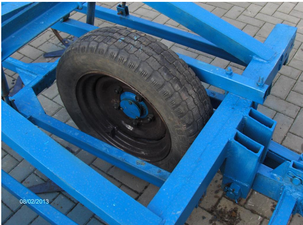
Рис. 9. Відновлена та удосконалена ходова частина культиватора КПС-4.
