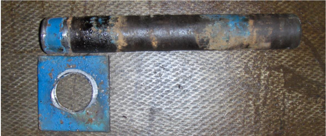
Рис. 7. Підготовка пальця для відновлення.
