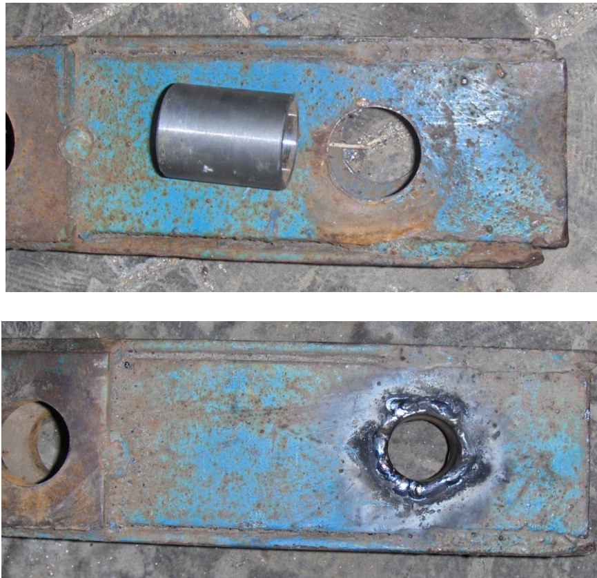
Рис. 6. Ремонт отвору кронштейна під палець механізму регулювання глибини обробки.
