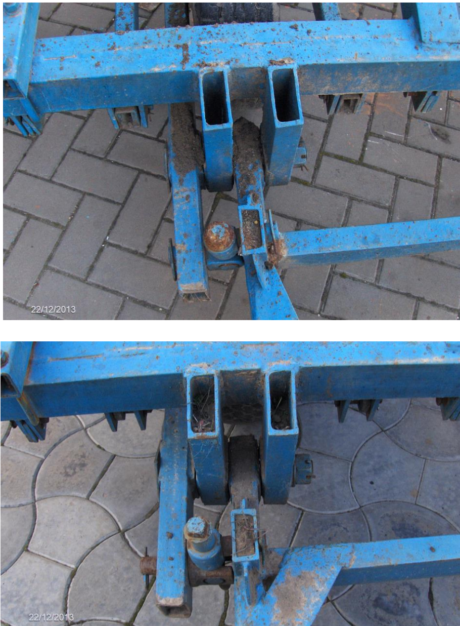
Рис. 10. Стан ходової частини культиваторів КПС-4 після року експлуатації.
