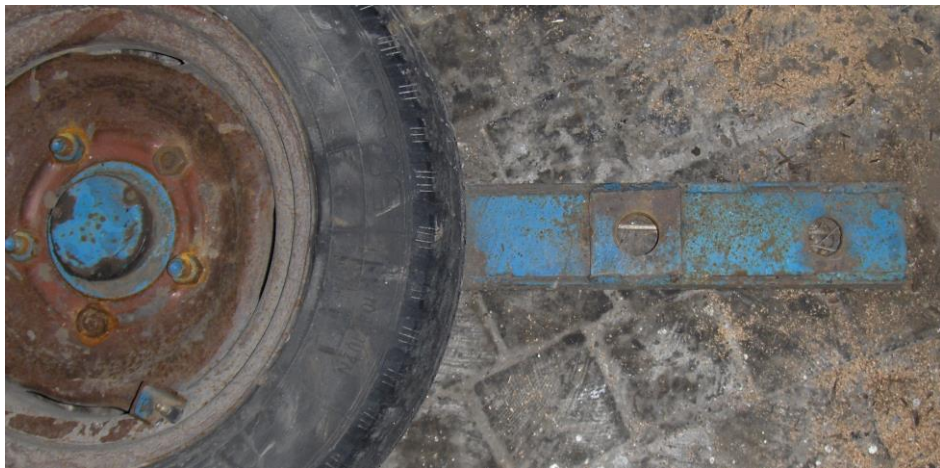
Рис. 4. Зазор між кронштейном та стійкою рами.
