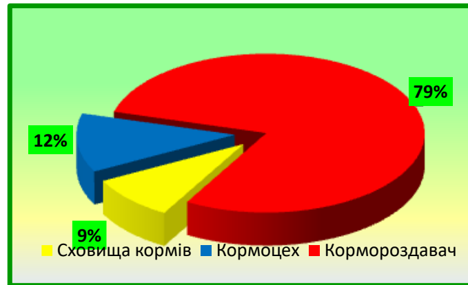
Рис. 1. Співвідношення відмов по елементах системи годівлі.
