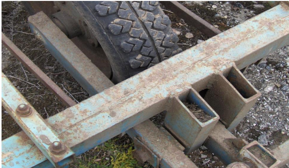
Рис. 4. Зазор між кронштейном та стійкою рами.
