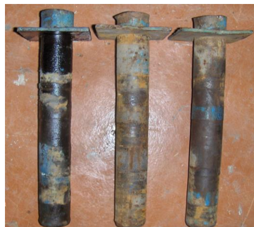
Рис. 5. Зноси деталей ходової частини культиватора КПС-4.
