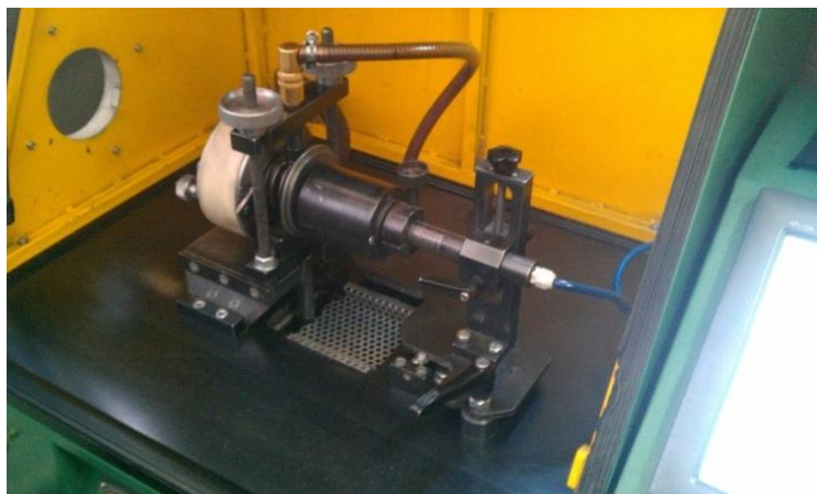
Рис. 8. Стенд для проведения испытаний турбокомпрессора
