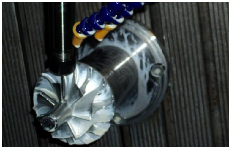
Рис. 7. Рабочее колесо, получаемое в результате обработки
