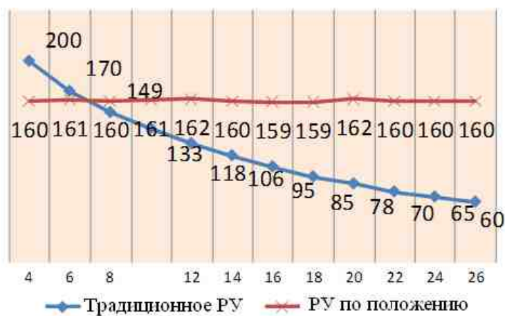
Рис. 5. Зависимость добротности от скорости движения транспортного средства (км/ч).
