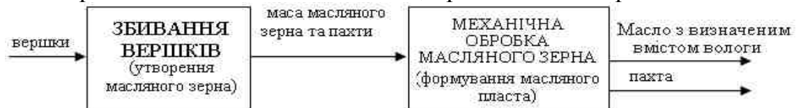
Рис. 1. Структурна схема процесу виробництва вершкового масла в МБД.
