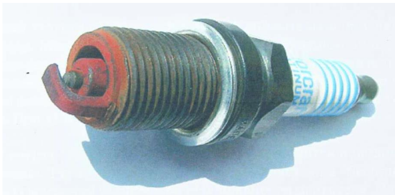
Рис.1. Червоний наліт на свічах запалювання.
