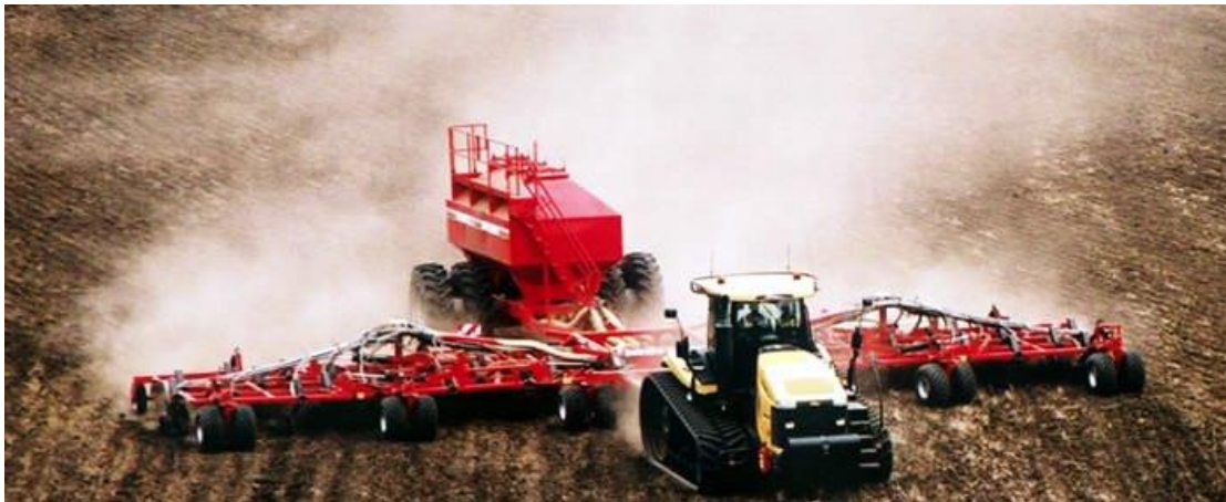
Рис.2. Агрегат для посіву озимої пшениці.
