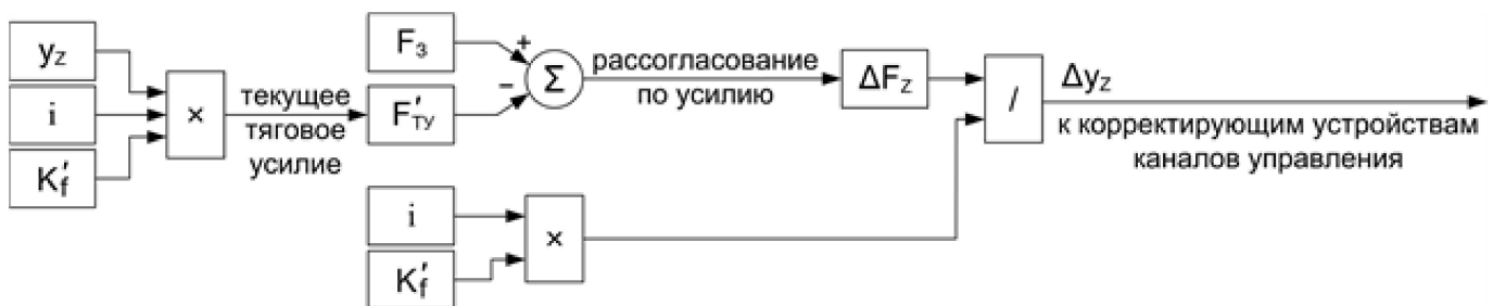
Рисунок 11 — Схема вычисления алгоритма изменения коэффициента K_f
