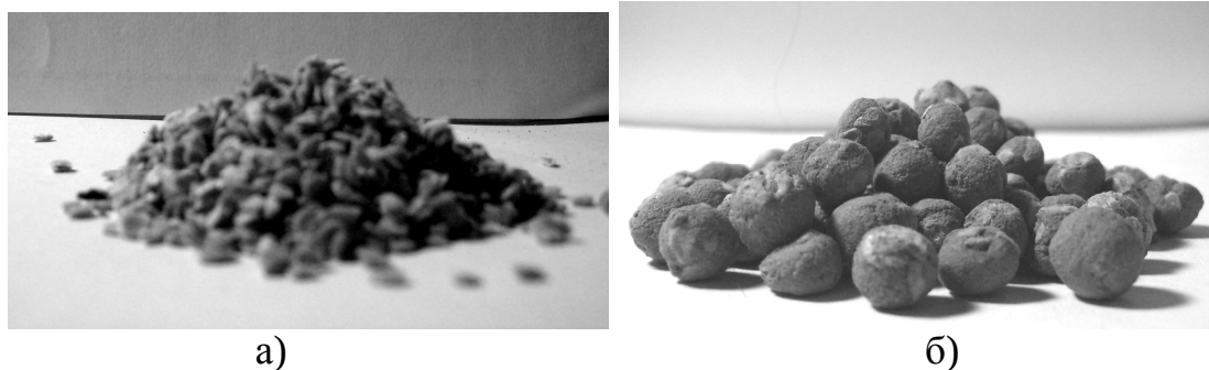
Рис. 2. Угол естественного откоса: а – обычные семена, б – капсулированные семена.
