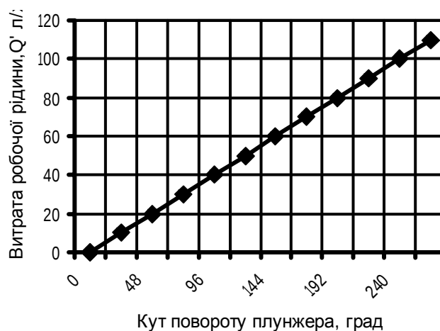
Рис. 6. Тарувальна характеристика витратоміра постійного перепаду тиску.
