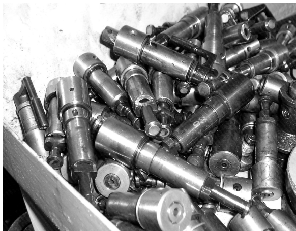
Рис. 1. Производственное испытание топливного насоса и выбраковка плунжерных пар.
