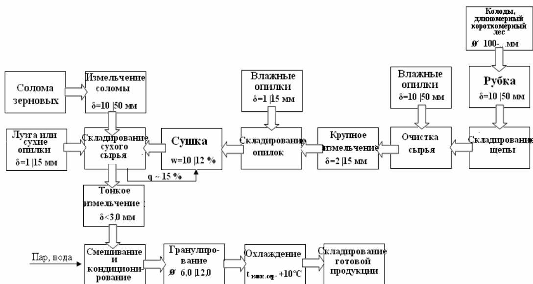
Рис. 1. Типовой технологический процесс получения твердого топлива.
