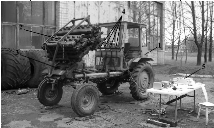
Рис. 1. Самохідне шасі Т-16МГ під час проведення досліджень: 1 – самохідне шасі Т-16МГ; 2 – імітатор ТМ; 3 – пристрій для агрегування; 4 – датчики вимірювання тиску ПМ-100; 5 – пристрій швидкодіючий самопишучий НЗ38-6П.
