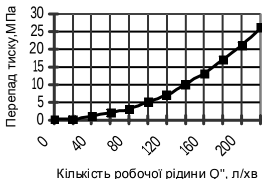
Рис. 8. Тарувальна характеристика витратоміра змінного перепаду тиску.
