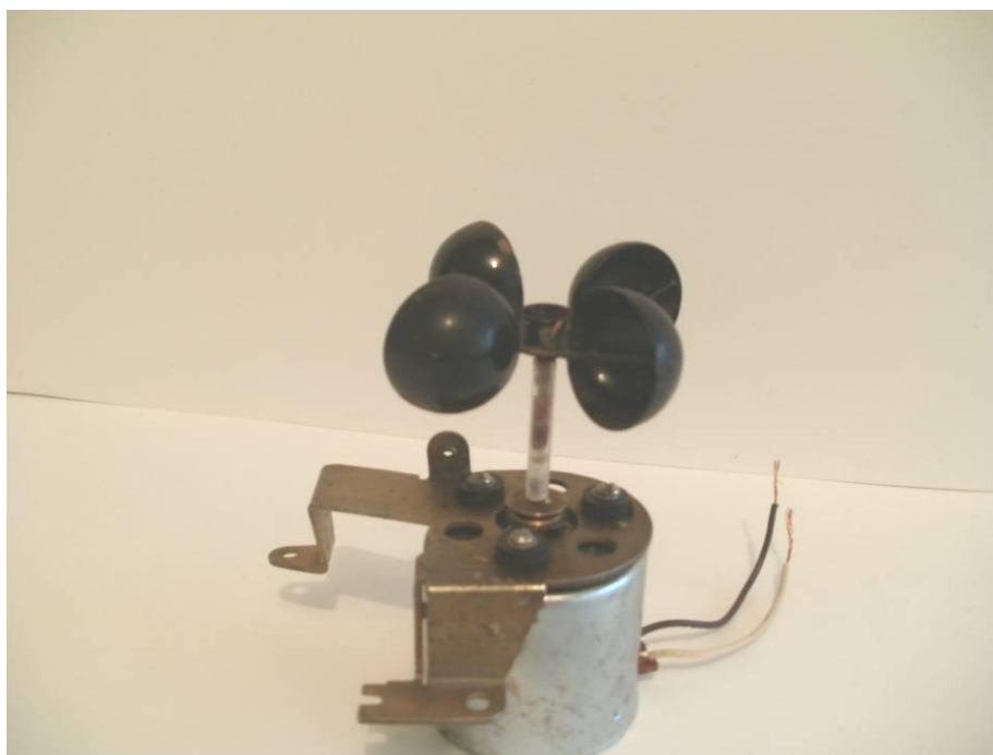
Рис. 4. Вимірювальний перетворювач швидкості вітру блоку автоматичного керування частотою обертання повітряних роторів вітроелектричного зарядного агрегату.
