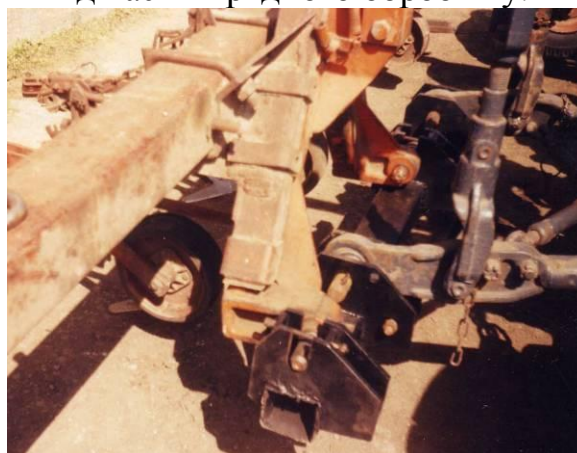
Рис. 1. Розміщення автоматичної зчіпки типу СА-2 з корегуючим пристроєм.
