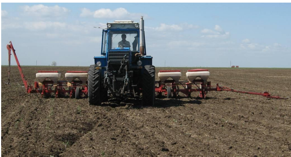
Рис. 3. Асиметричний посівний агрегат у складі трактора ХТЗ-16131 та 12-рядної просапної сівалки «Optima».
