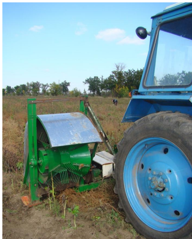
Рис.1. Агрегат для збирання рицини методом обчисування: а – технологічна схема; б – загальний вид; 1 – трактор колісний; 2 – збиральний модуль.
