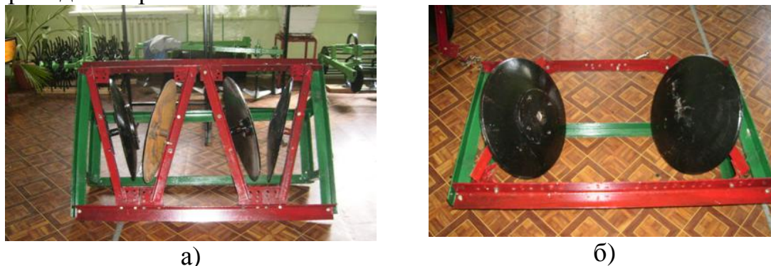
Рис. 2. Конструктивное решение установки углов \alpha и \beta сферических дисков на раме полевой установки: а) регулирование угла атаки \alpha диска; б) регулировка угла наклона \beta диска.
