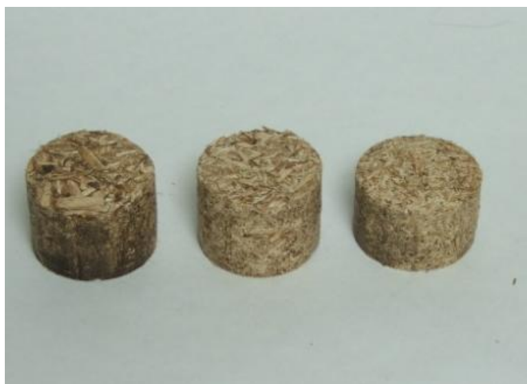
Obr. 2. Topné brikety lisované z topolové štěpky.
