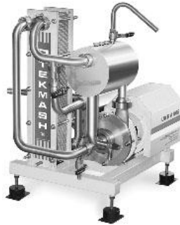
Рис. 1. Загальний вид гідродинамічної установки ТЕК-ПП
