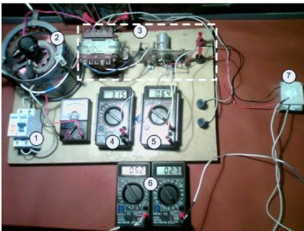
Рис. 1. Зовнішній вигляд іспитового стенда: 1 – автоматичний вимикач; 2 – ЛАТР; 3 – випрямляч; 4, 5, 6 – мультиметри для виміру постійної напруги, струму й температури відповідно; 7 – ТЕМ Пельт'є
