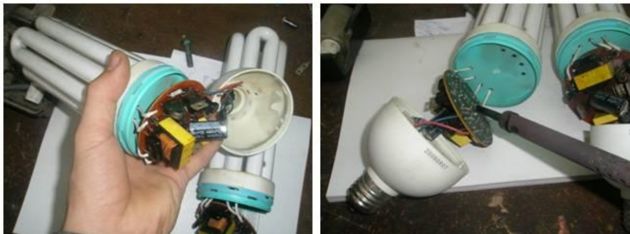
Рисунок 3. - Ремонт компактної лампи Delux EQS-06, E27, 65 Вт на підприємстві
