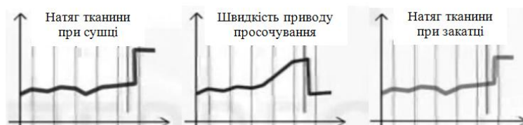
Рисунок 2 – Графіки залежності натягу при сушці, швидкості та натягу закатки у часі.
