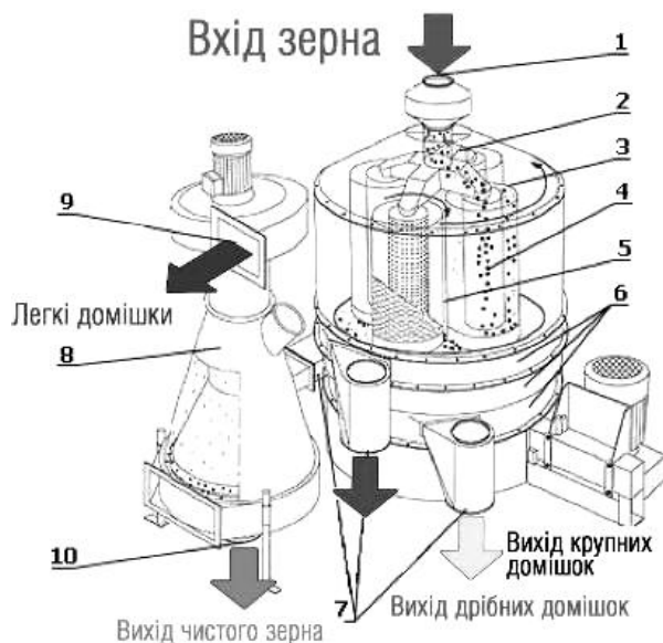
Рис. 1. Принцип дії зерноочисної машини Prof-Seed
