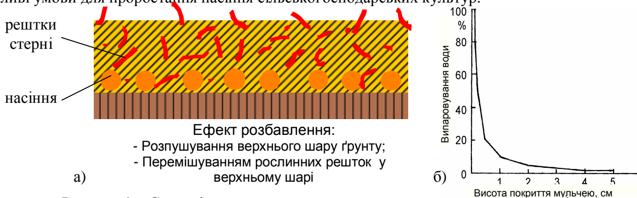
Рисунок 2 – Схема формування мульчувального шару для мульчуючої сівби с.-г. культур (а) та залежність інтенсивності випаровування вологи із ґрунту (%) в залежності від висоти покриття її мульчею (б)
