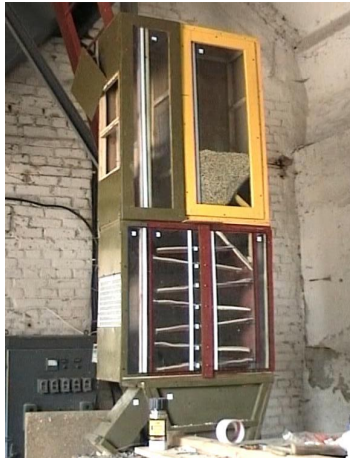
Рис. 1. Зовнішній вигляд зерносушарки з киплячим шаром каскадного типу
