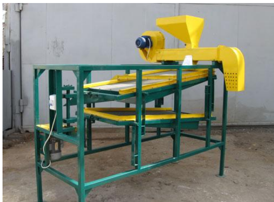
Рис. 2. Дослідно-промислова установка НВЧ знезараження комбікорму в псевдозрідженому шарі
