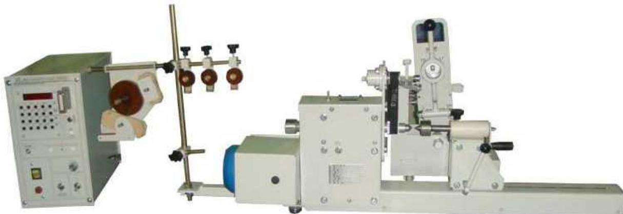
Рисунок 1 – Станок для намотки якорей СНЯ-0,8
