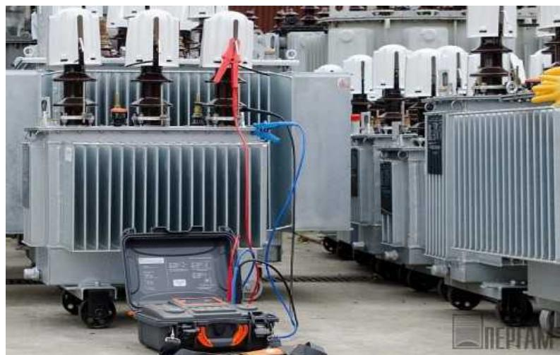
Рисунок 1 – Діагностика ізоляції за допомогою мобільного пристрію
