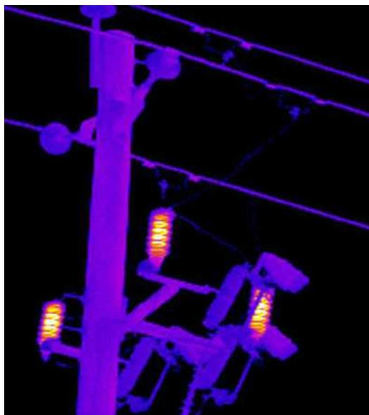
Рисунок 2 - Тепловізійне обслідування ОПН
