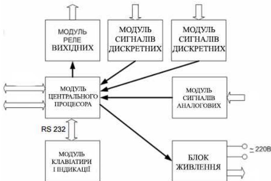
РИС.1 - СКЛАДНІ ЧАСТИНИ РЕЛЕ MP-500
