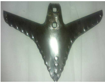
Рисунок 3 - Культиваторна лапа з криволінійним локально зміцненим лезом після напрацювання 20 га [11].
