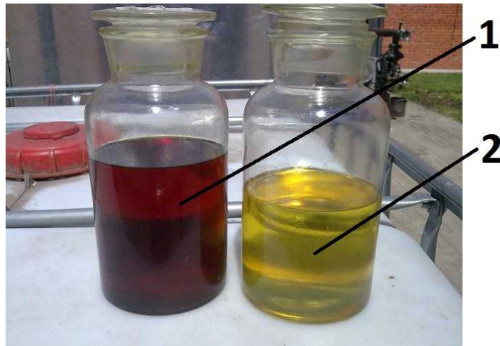
Рисунок 1 - Трансформаторне масло до і після регенерації на установці СММ-Р: 1 - трансформаторне масло до регенерації на установці СММ-Р, 2 - трансформаторне масло після регенерації на установці СММ-Р
