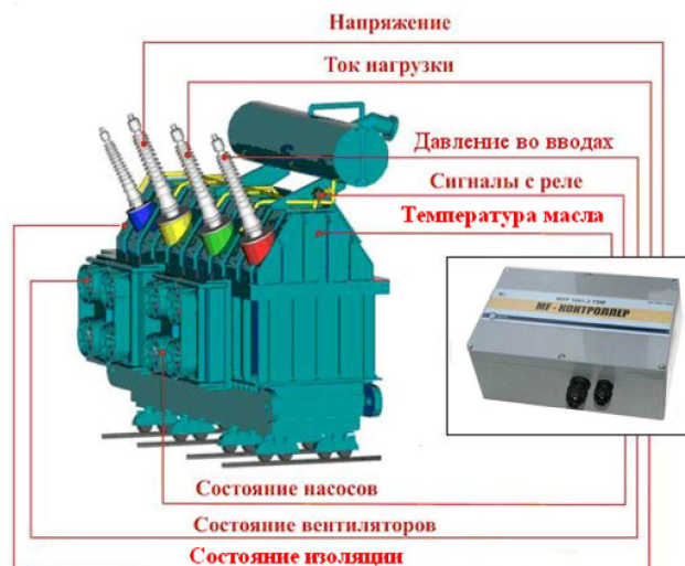
Рисунок 1 - Стационарна система моніторингу та діагностики силових трансформаторів
