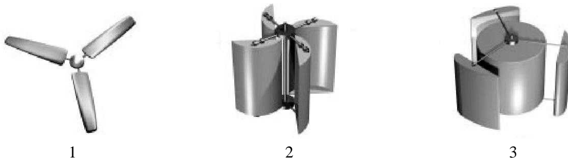
Рис.1. Класифікація ветроустановок по положенню ротора:
