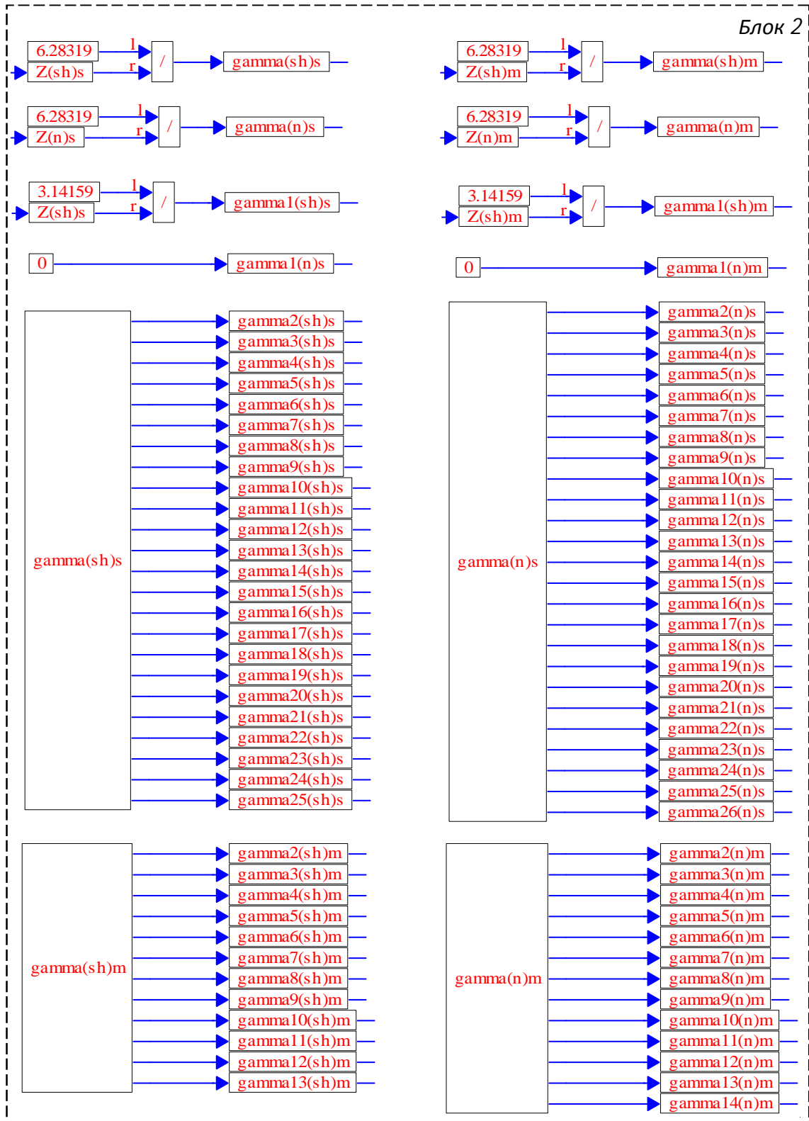
Рис. 2. Блок определения углов расположения центров зубьев шестерни и направляющей серийного и модернизированного
