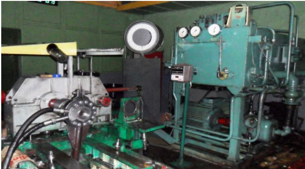
Рис. 1. Стенд для испытания гидравлических вращателей планетарного типа
