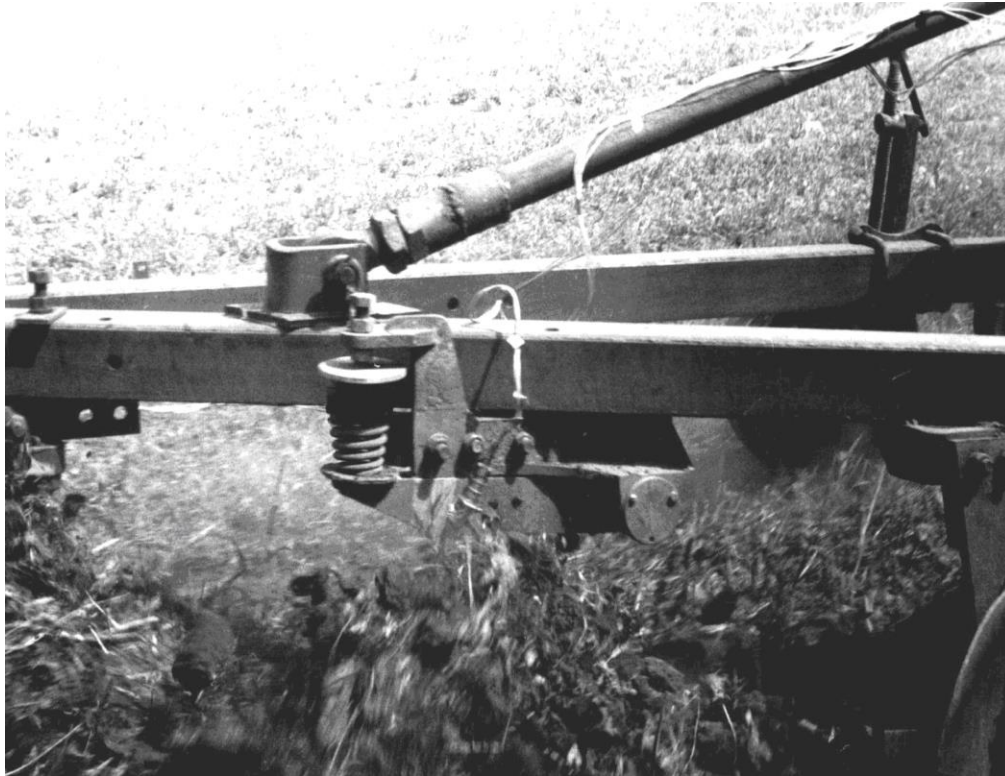
Рис. 10. Науково-виробниче дослідження корпусу плуга на пружній підвісці.
