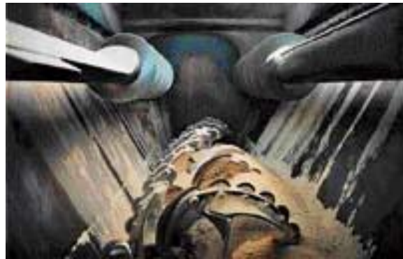
Рис. 2. Змішувально-подрібнюючі шнеки у бункері кормозмішувача-роздавача DeLaval-12
