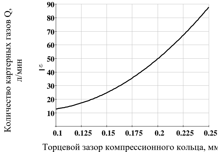
Рис. 3. Влияние зазора в сопряжении «гильза-поршень» на количество картерных газов
