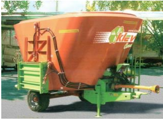
Рис. 3 – Вертикальний міксер - кормороздавач Cormorant Vertical МК-11В
