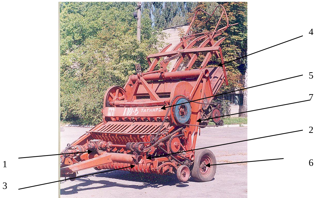
Рис. 2. Підбирач-навантажувач сіна та соломи ПНС-1,8
