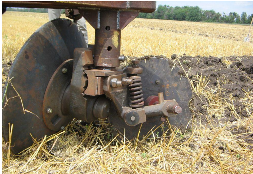
Рис. 3. Механизм крепления диска к стойке
