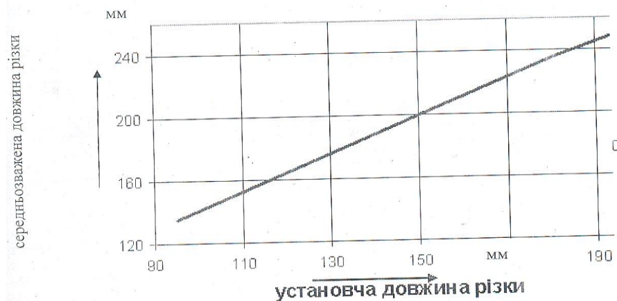
Рис. 5. Зміна середньозваженої довжини різання, в залежності від встановленої відстані між дисковими ножами
