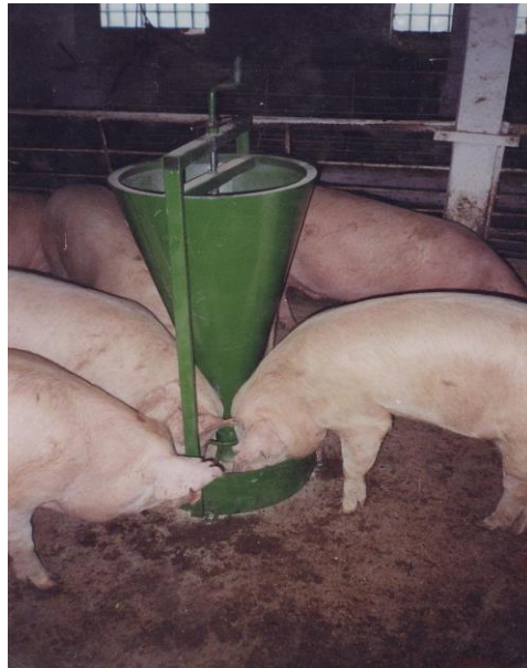
Рис. 2. Кормовой автомат КАМ - 1
