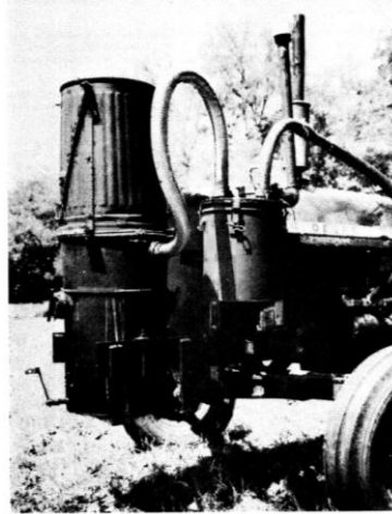
Рис. 3. Загальний вид транспортного газогенератора, встановленого на тракторі із двигуном потужністю 26 кВт [2]
