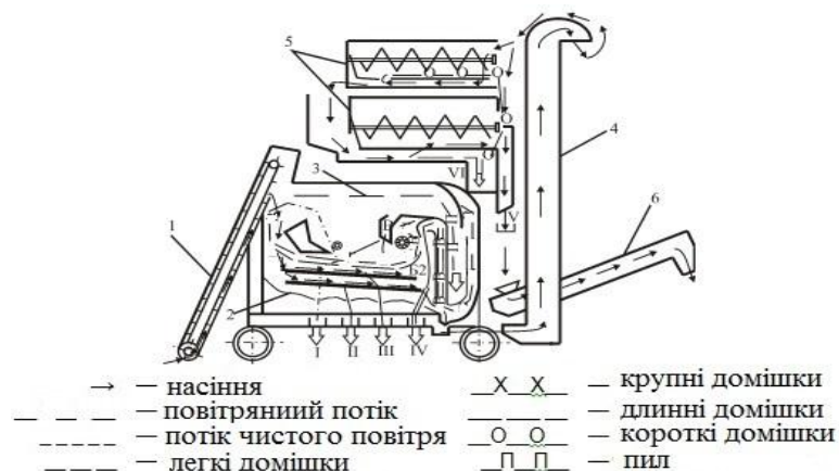
Рис. 1. Схема технологічна машини МС-4,5: 1 – скребковий
