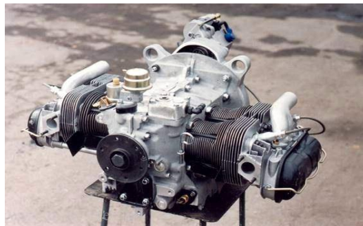
Рис. 1. Первые опозитные двигатели Фольксваген Жук
