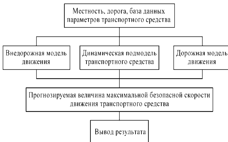
Рис. 2. Алгоритм работы модели АМС-71
