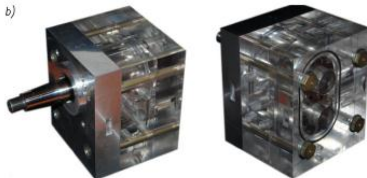
Рис. 4. Конструкция экспериментального насоса
