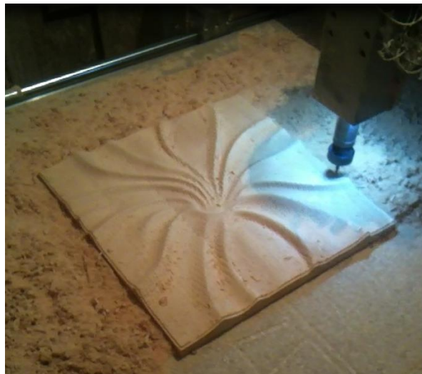
Рисунок 4 – Обробка декоративних елементів на верстаті з ЧПУ
