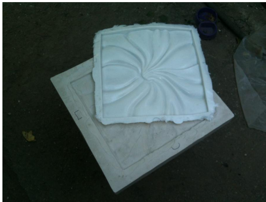
Рисунок 5 – Процес створення силіконової ливарної форми
