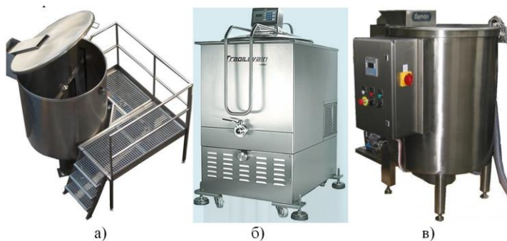
Рисунок 1.3 - Виготовлювачі рідких заквасок: а) – Т-1000 Topos; б) – RADILEVAIN TL40; в) – Т-500 Topos.
