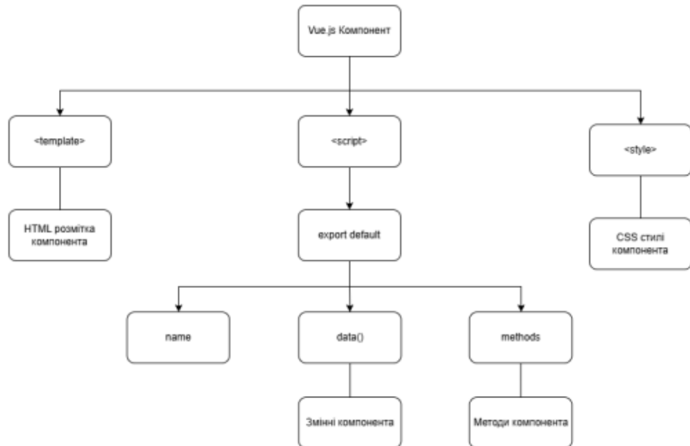
Рис. 1. Графічне зображення структури компонента Vue.js
