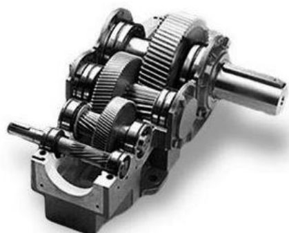
Рисунок 6.11 – Зовнішній вид редуктора: а - редуктор циліндричний двохступінчастий; б - редуктор циліндричний трьохступінчастий
