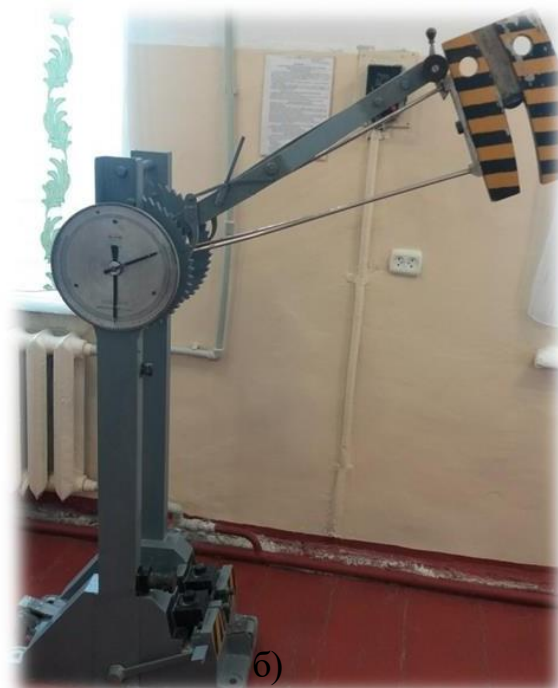
Рисунок 4.10 – Маятниковий копер МК-30: а) схема копра, б) зовнішній вигляд копра.
