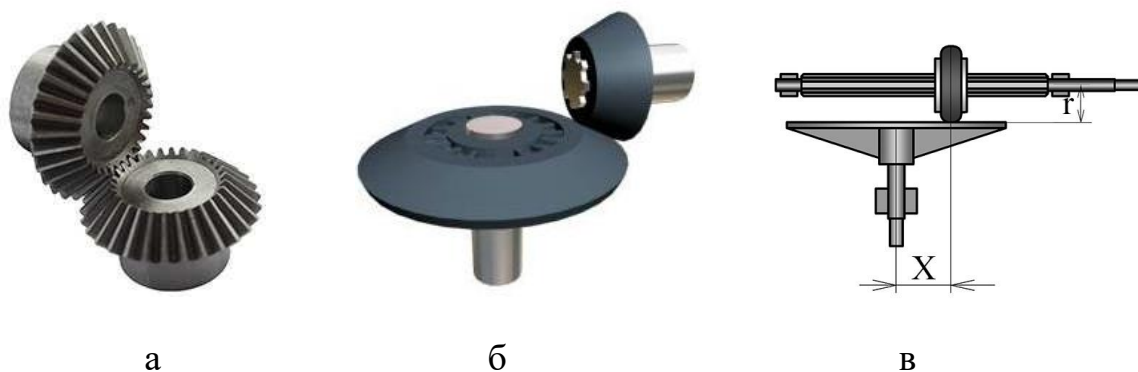
Рисунок 7.9 – З перетинаючими валами: а – зубчасті конічні; б – фрикційні конічні; в – фрикційні лобові;
