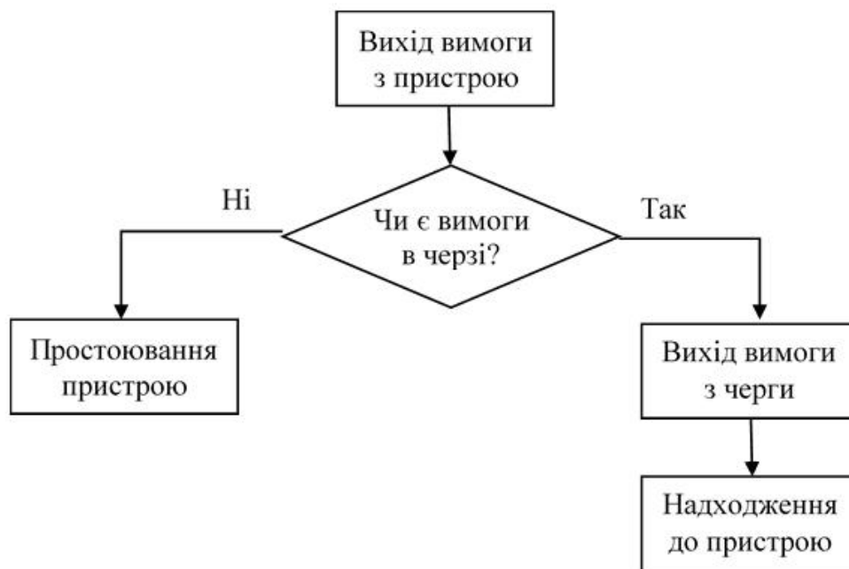
Рисунок 5.2 – Логічна блок-схема одноканальної СМО
