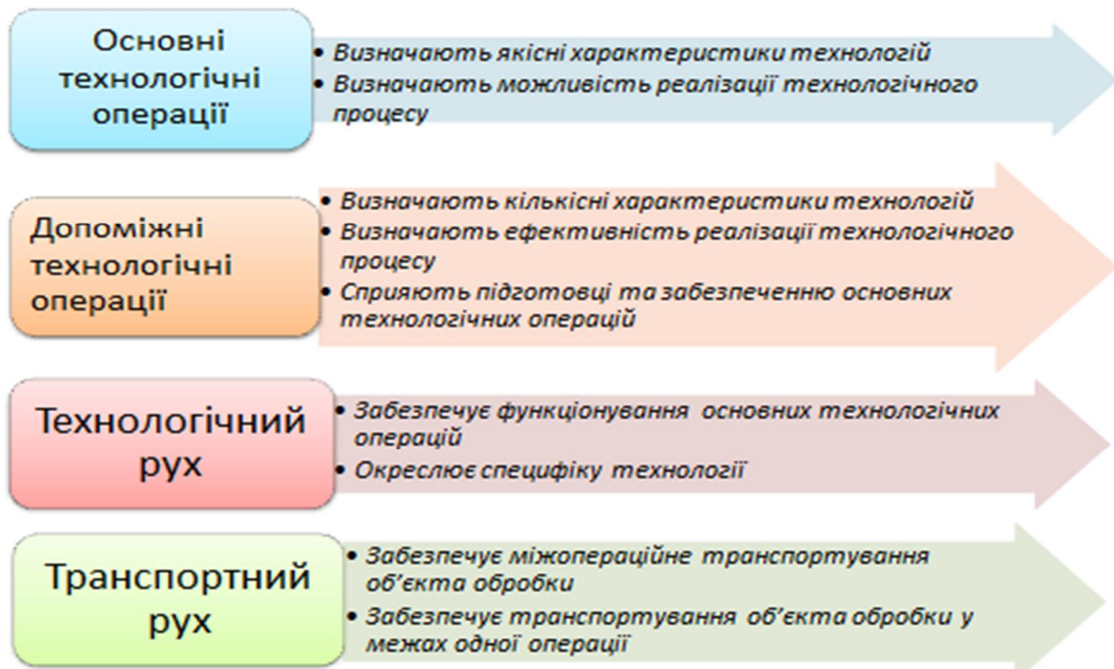
Рисунок 4.3 – Технологічний та транспортний рухи технологічної системи
